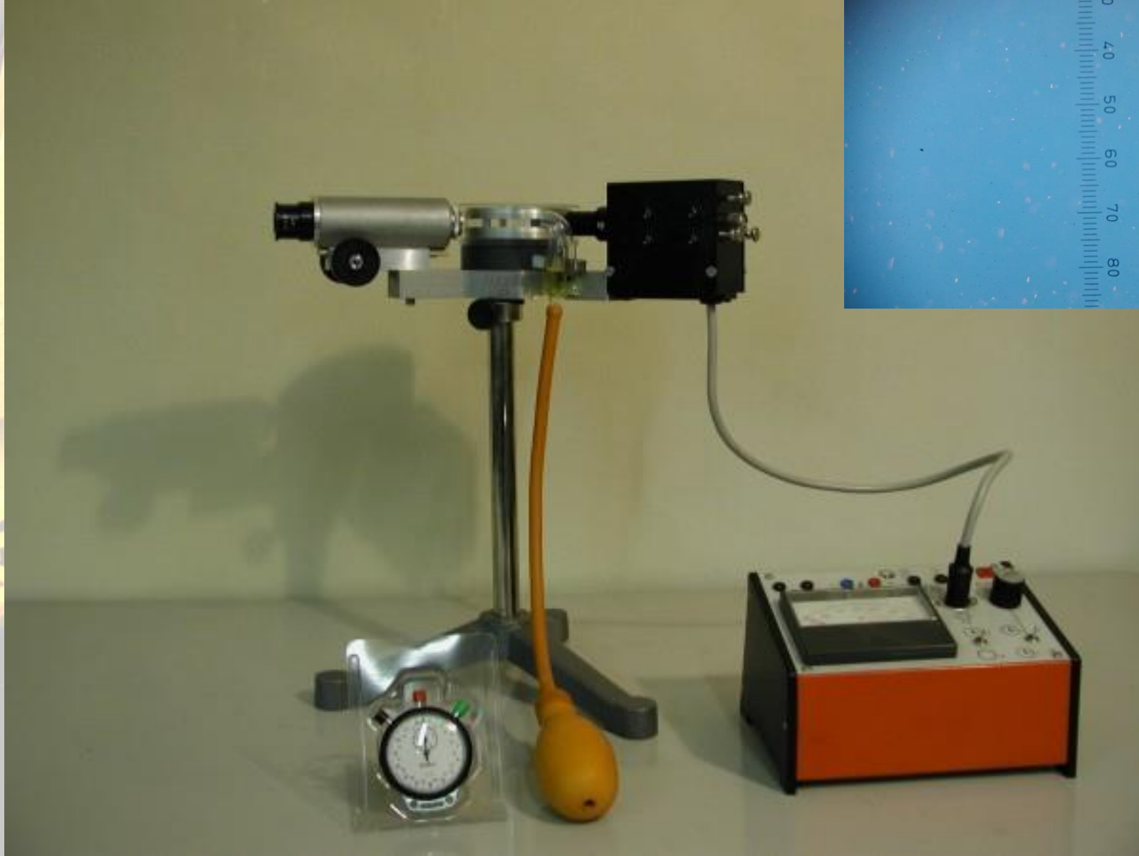
Millikanův experiment na FJFI
